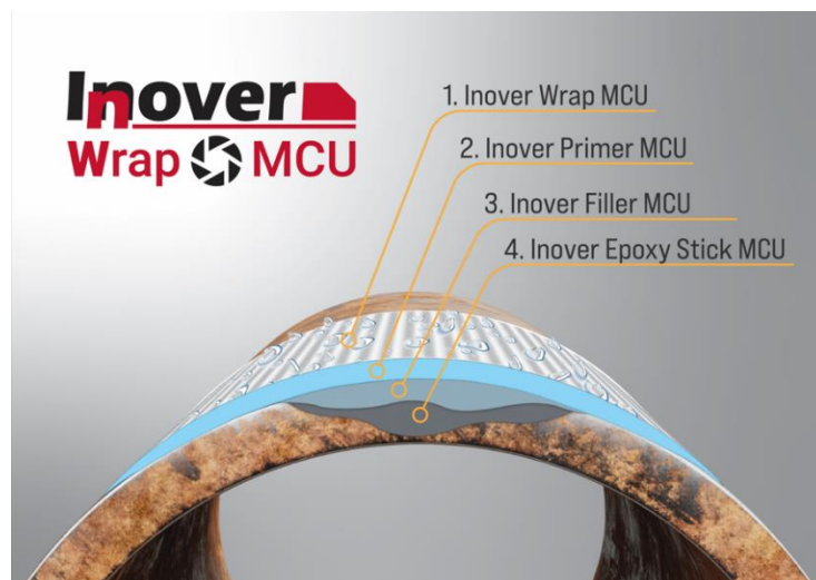
Rys. 1. Schemat systemu kompozytowego
